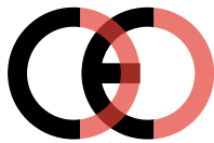
Faux marquage CE (trop proche)
